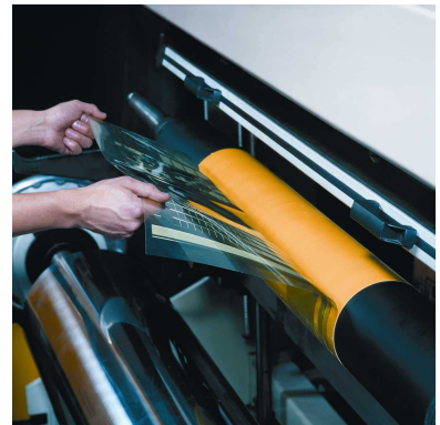
写真6 刷版を剥がす(60度方向)
